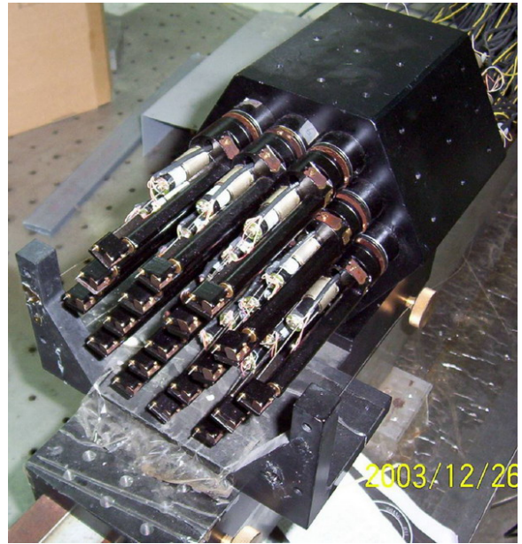
中国科技大学研制的 LAMOST 并行可控式光纤定位试验系统，带有 19 个定位单元
