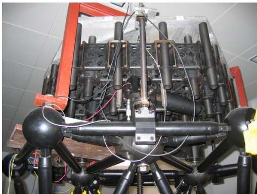
复杂的 MA 子镜支撑，图中黑色部分为桁架和力触动物器
